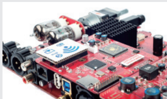
Pro iDSD のデジタル処理部。ガルバニックアイソレーションを介しXMOS へ入力される
